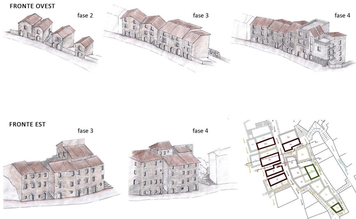
Fig. 6 Esempio di ipotesi delle principali fasi di formazione e trasformazione di un tessuto urbano. Via della Concordia. (Cfr. Credits).
