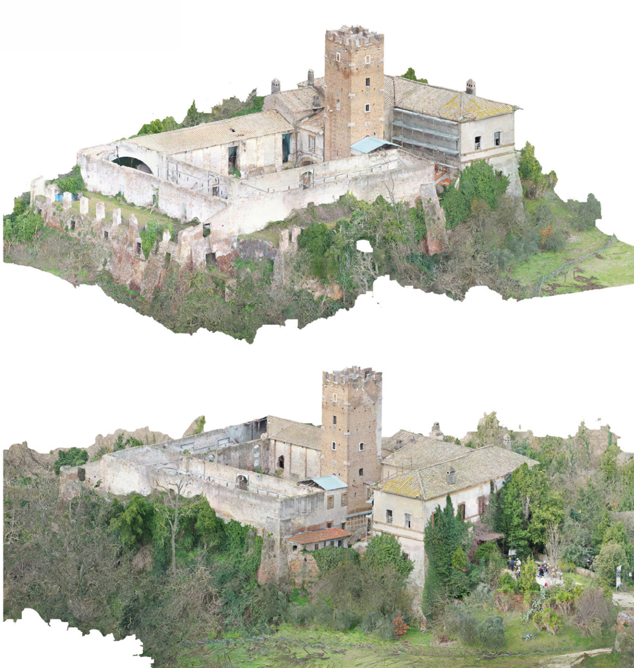
Fig. 2. Ortomosaico ricavato da nuvola di punti eseguita con foto aerea da drone (gruppo di lavoro: T. Celi, F. Ravizza, A. Pallotta, R. Picca Orlandi, S. Tatulli su rilievo fotografico di M. Canciani).
