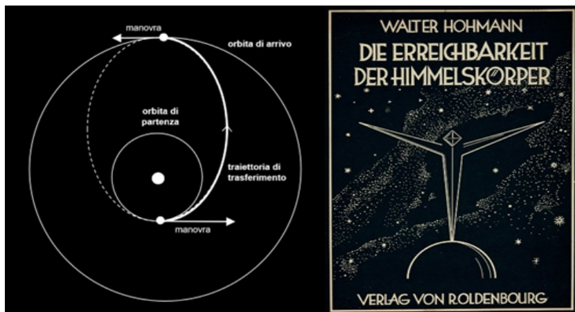
Fig. 3. Le traiettorie di trasferimento di Hohmann congiungono due orbite circolari attorno allo stesso corpo centrale, quindi valgono sia per le orbite eliocentriche percorse da una sonda interplanetaria, che per quelle geocentriche dei satelliti artificiali attorno alla Terra (a sinistra, elaborazione dell'autore); la copertina del libro di Hohmann, pubblicato nel 1925 (a destra)
