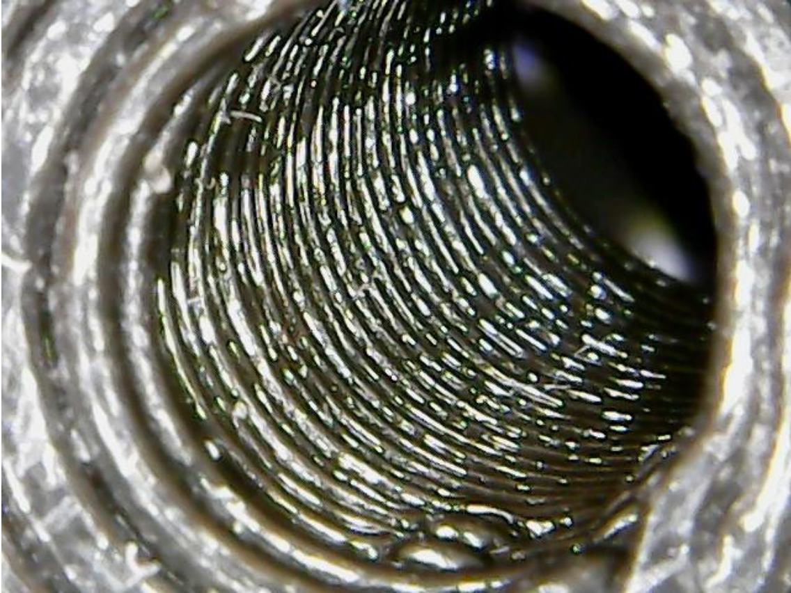
Figura 3.6 – Dettaglio al microscopio digitale della superficie interna del collo di un campione. Sono visibili imperfezioni superficiali dovute alla risoluzione limitata della stampa FDM.
