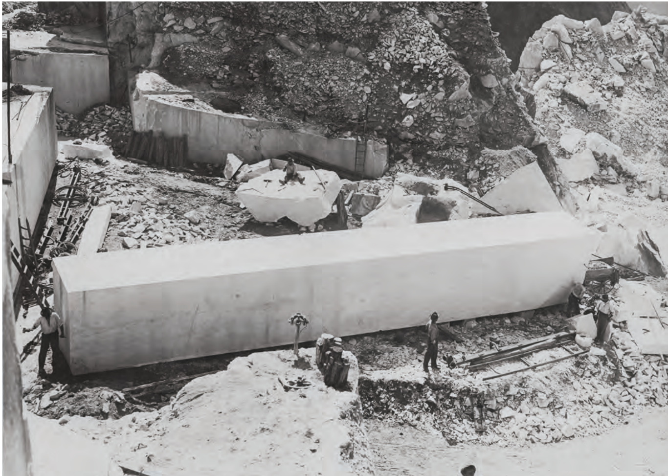
Il Monolite marmoreo di 17,40 m di altezza e del peso di 380 tonnellate fu estratto nelle cave delle Alpi Apuane (MAXXI CA, Fondo Enrico Del Debbio).
