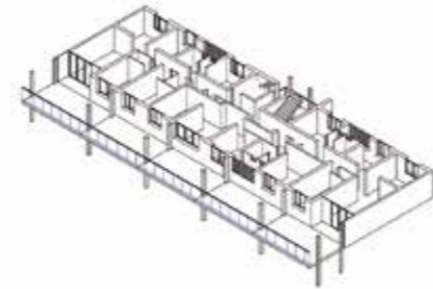
3. POSE DES POTEAUX
