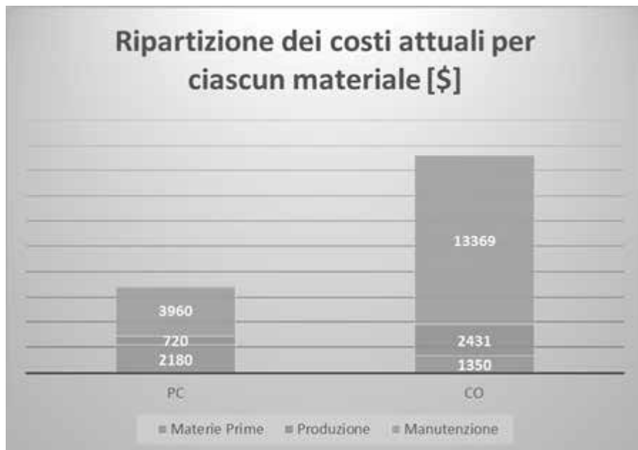
Figura 4: Ripartizione dei costi annuali per lo stesso elemento di tubatura realizzato con Calcestruzzo Polimero e con Calcestruzzo Ordinario
